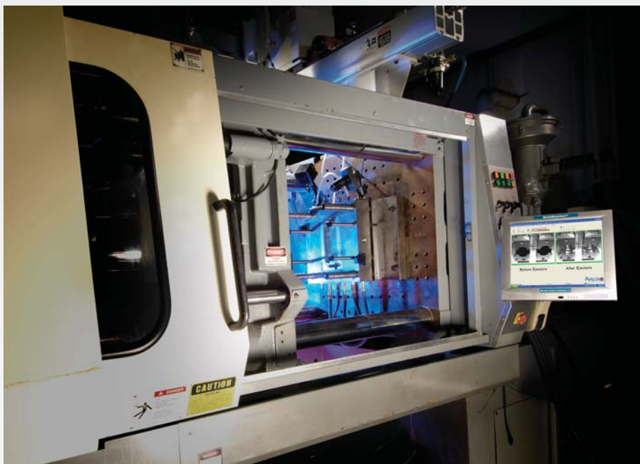
MoldWatcher 模具监测仪和机械手或浇口取出机配套，工作效果一样好。
